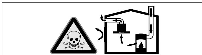
Oda havasına bağlı ısı kaynakları (örneğin gaz, yağı, odun veya kömürle çalışan sobalar, şofbenler, su ısıtıcıları) yanma havasını kurulum yerinden alırlar ve atık gazı bir atık gaz sistemi (örneğin baca) kanalıyla dışarıya aktarırlar.
