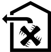
Zassane powietrze jest czyszczone przez filtr przeciwłuszcza i kierowane na zewnątrz poprzez system rur.
