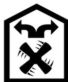
Nasátý vzduch se čistí pomocí tukového filtru a aktivního uhlíkového filtru a přivádí se zpět do kuchyně.
