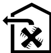
Вытяжка всасывает воздух, который очищается, проходя через жироулавливающие фильтры, а затем выводится по системе труб наружу из здания.
