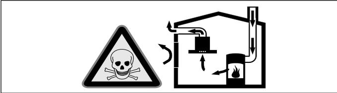
Hava dolaşımli ateşlikler (örneğin gaz, yağ, odun veya kömürle çalışan sobalar, şofbenler, su ısıtıcıları) yanma havasını kurulum yerinden alırlar ve atık gazı bir atık gaz sistemi (örneğin baca) kanalıyla dışarıya aktarırlar.
